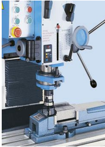
Milling with milling arbor (phay với trục gá)
