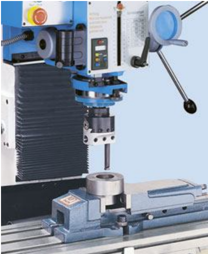
Inside diameter boring and facing (khoan và lót đường kính trong)
