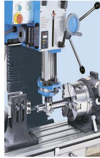
Slot cutting with divider (Rãnh cắt và bộ dẫn hướng)
